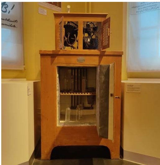
Abb. 9: Absorber Kühlschrank. Mannesmann Kälte-Industrie, Berlin, um 1925. Auf Kosten des FFK von Ammoniak befreit
